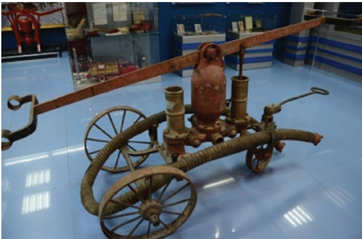
Пожарный насос XIX века, изготовленный немецким механиком Густавом
